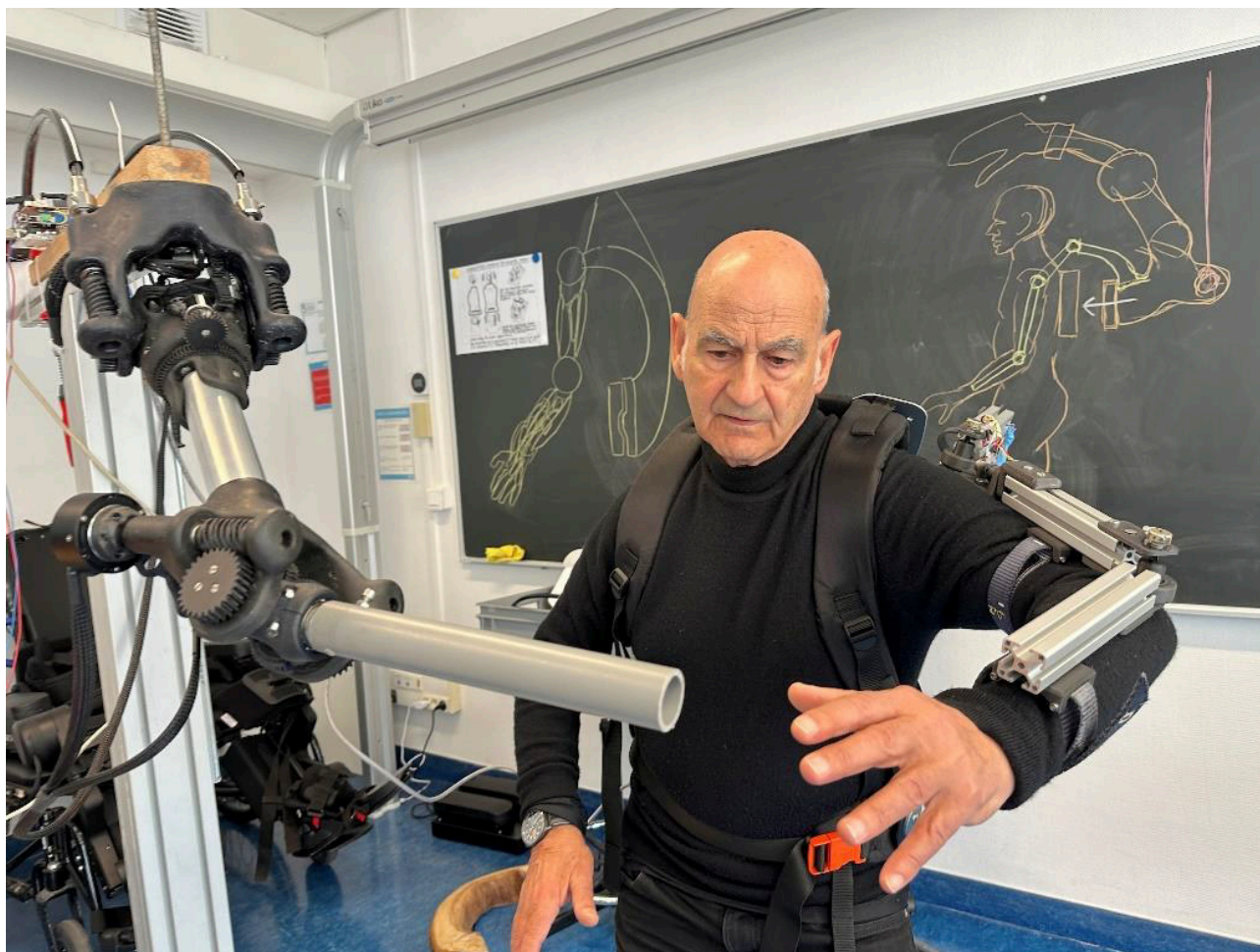
Figure 3 : Photo d'une session de co-conception à l'ISIR, impliquant un premier prototype de bras sans main. L'artiste porte un exosquelette qui mesure les mouvements des articulations de son bras gauche afin de générer ceux du bras, à travers des filtres et une reprojction algorithmique.
